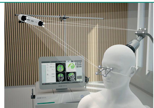
S22-05 Fig. 1: The Neurolith system for TPS treatment mit 3D Camera, navigation system und TPS handpiece
