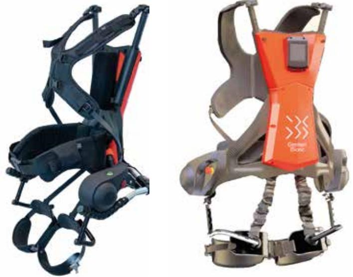
Abb. 1: Exoskelett Cray-X, Ansicht von seitlich vorn (links) und hinten (rechts)
