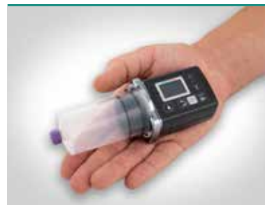
Abb. 1: Klein, leicht und einfach zu handhaben: die Crono LECIG Pumpe
