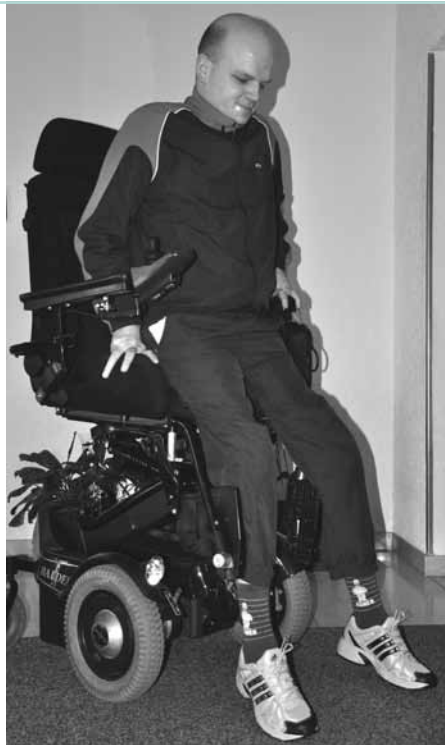
Abb. 3 (Mitte): Elektrorollstuhl mit Hubfunktion zum Aufstehen
