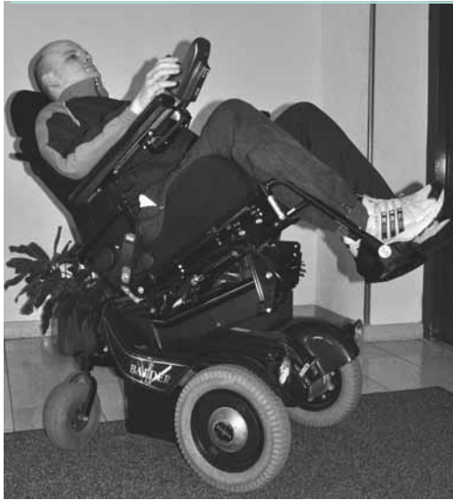
Abb. 2 (links): Elektrorollstuhl mit Liegefunktion
