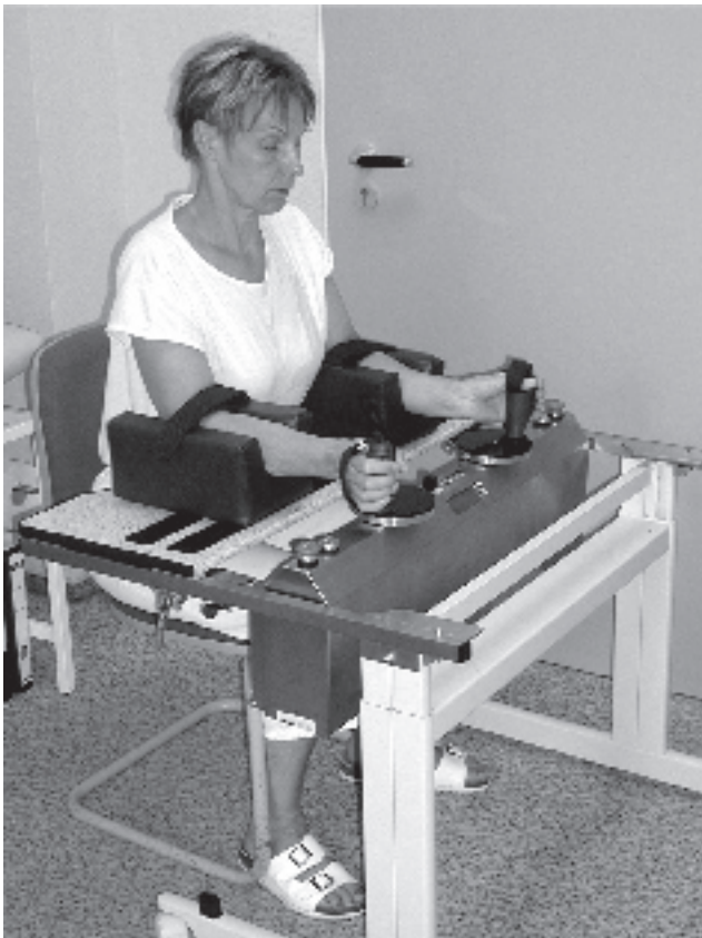
Abb. 1: computergestützter Armtrainer, ein links-hemiparetischer Patient übt eine repetitive bilaterale Pro- und Supination des Unterarms auf dem Armtrainer
