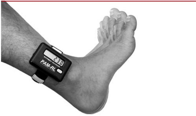
**Abb. 2:** PLM-Bewegungssensor »PAM-RL« der Firma SOMNOmedics. Das Gerät kann Liegen und Stehen voneinander differenzieren und kann bis zu 72 Stunden kontinuierlich aufzeichnen.
